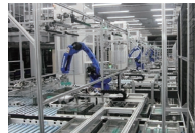
物流工程におけるキット箱の自動作成の様子
