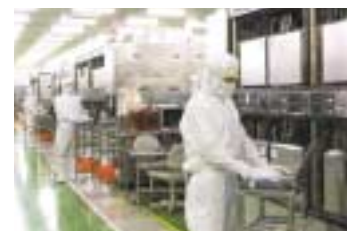
東京エレクトロンで最も売上規模の大きい、コータデベロッパ-CLEARN TRACK ACT® 8の製造ライン。クリーンルームの中で高度な半導体チップの生産を担う装置が量産される。
